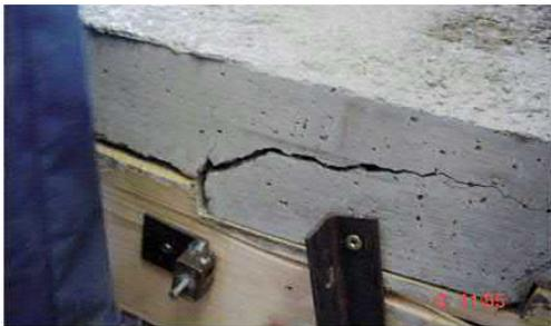
Abb. 5: Konsolversagen Beton, aus [7]
